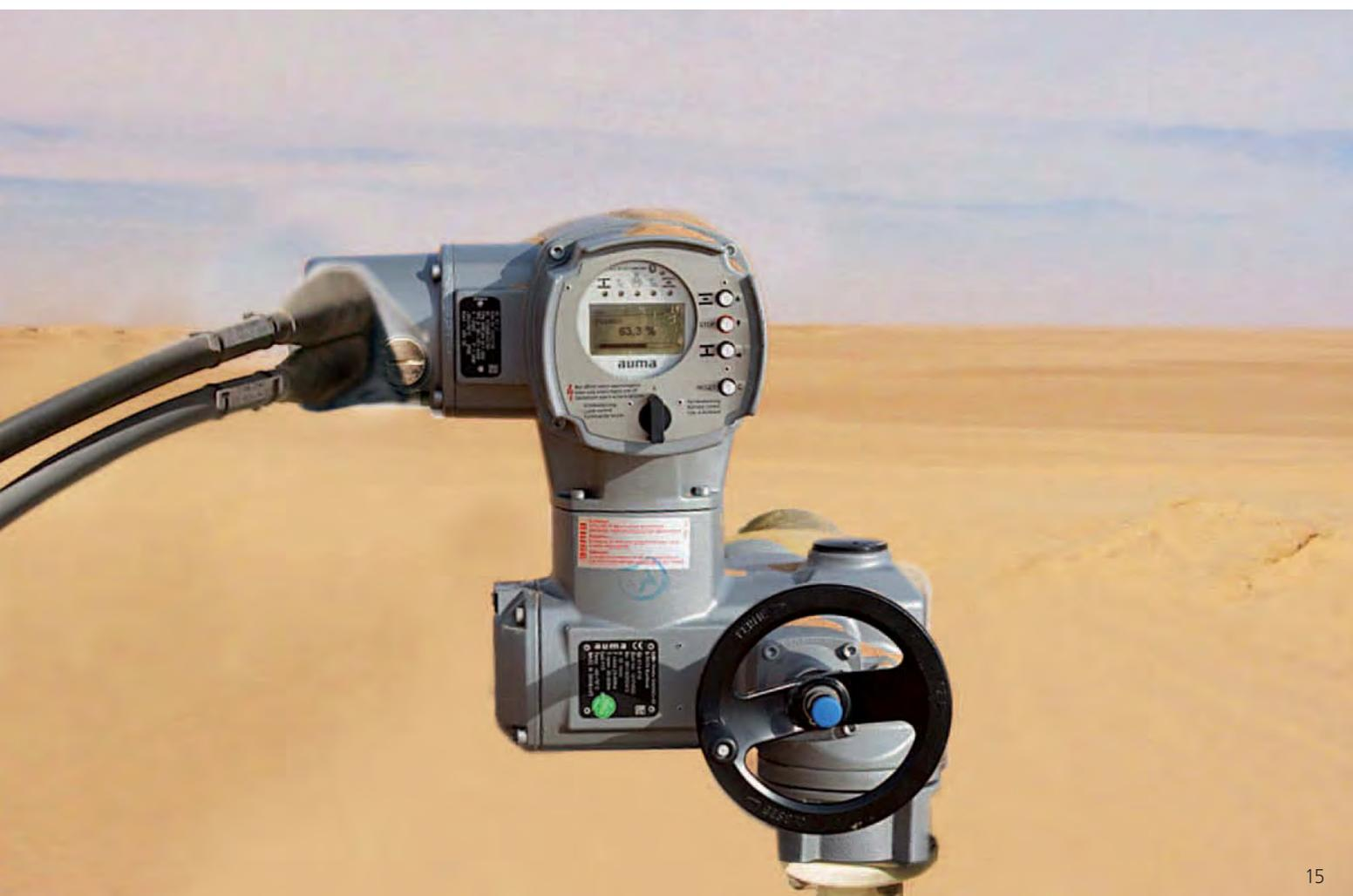
Для обеспечения долговечности оборудования особенно важна эффективная защита от коррозии. Антикоррозионная защита электроприводов AUMA осуществляется в два этапа: предварительная химическая обработка поверхности и нанесение порошка в два слоя на отдельные комплектующие. В соответствии с категориями коррозионной активности (стандарт EN ISO 12944-2) выделяются различные уровни защиты для соответствующих областей применения.
