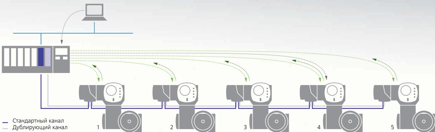
**Цикл шины с 5 электроприводами**
