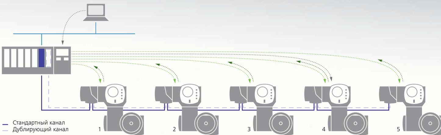
Цикл шины с 5 электроприводами
