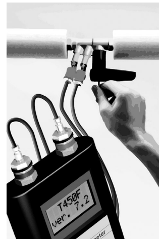
Рис. 7 Измерение расхода на клапане БРОЕН Venturi
