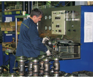
Тестирование шаровых кранов
