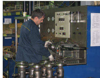
Тестирование шаровых кранов
