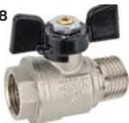
Кран шаровой, латунный, резьбы внутренняя-наружная (под универсальный соединитель для труб) по ISO 228/1, "бабочка" из алюминия. Температура рабочей среды от -20°C до +120°C.
