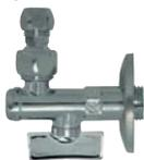
Миникран шаровой, латунный, угловой с фильтром для смесителей хромированный, резьбы наружная по ISO 7/1 - шарнирная цапга для медной трубы, "флажок" из алюминия хромированный + декоративная розетка (арт. 1005)
