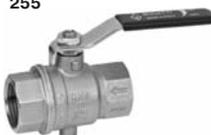
Кран шаровой латунный, полнопроходной, с автоматическим сливом, резьбы внутренняя - внутренняя по ISO 7:2000, рычаг из стали. Кран является однонаправленным.
