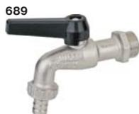
689 Кран шаровой, латунный, водоразборный, резьбы наружная по ISO 228/1-штуцер с накидной гайкой, рычаг из алюминия.
