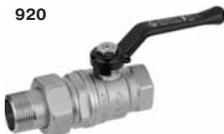
Кран шаровой, латунный, полнопроходной, резьбы внутренняя - наружная (соединитель с накидной гайкой) по ISO 228/1, рычаг из алюминия
