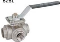
Кран шаровой, латунный, 3-ходовой тип L, полнопроходной, резьбы внутренняя-внутренняя-внутренняя по ISO 7/1, рычаг из алюминия
