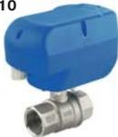
Кран шаровой, латунный, полнопроходной, с электроприводом 220V, 30 сек., IP65, резьбы внутренняя - внутренняя по ISO 7/1
