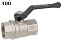
Кран шаровой латунный усиленного типа, резьбы внутренняя - внутренняя по ISO 7:2000, рычаг или "бабочка" из алюминия.
