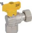
Кран шаровой для газа, латунный, резьбы наружная по ISO 7/1 - накидная гайка по ISO 228/1, "бабочка" из алюминия
