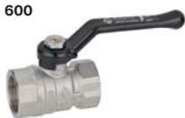
Кран шаровой латунный стандартный, резьбы внутренняя - внутренняя по ISO 228/1, рычаг или "бабочка" из алюминия.
