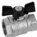
Кран шаровой, латунный, полнопроходной, резьбы внутренняя-внутренняя по ISO 228/1, "бабочка" из алюминия
