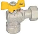
Кран шаровой, для газа, латунный, угловой, полнопроходной, резьбы внутренняя по ISO 7/1 - накидная гайка по ISO 228/1, "бабочка" из алюминия. Температура рабочей среды от -20°C до +60°C.
