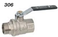
Кран шаровой латунный, полнопроходной, резьбы внутренняя - наружная по ISO 228/1, рычаг из стали
