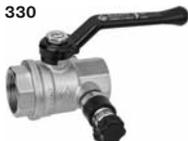
Кран шаровой латунный, полнопроходной, со сливным клапаном, резьбы внутренняя - внутренняя по ISO 228/1, рычаг из алюминия или стали
