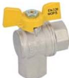
Кран шаровой, для газа, латунный, угловой, усиленного типа, полнопроходной, резьбы наружная-внутренняя по ISO 7/1, "бабочка" из алюминия. Температура рабочей среды от -20°C до +60°C.
