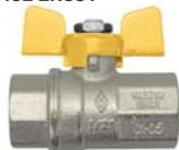
Кран шаровой, для газа, латунный, усиленного типа, полнопроходной, резьбы внутренняя-внутренняя по ISO 7/1, "бабочка" из алюминия. Температура рабочей среды от -20°C до +60°C.
