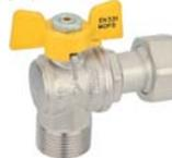
Кран шаровой, для газа, латунный, угловой, полнопроходной, резьбы наружная по ISO 7/1 - накидная гайка по ISO 228/1, "бабочка" из алюминия. Температура рабочей среды от -20°C до +60°C.
