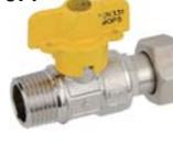
Кран шаровой для газа, латунный, резьбы наружная по ISO 7/1 - накидная гайка по ISO 228/1, "бабочка" из алюминия
