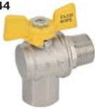
Кран шаровой, для газа, угловой, латунный, усиленного типа, полнопроходной, резьбы внутренняя-наружная по ISO 7/1, "бабочка" из алюминия. Температура рабочей среды от -20°C до +60°C.
