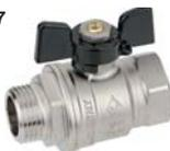
Кран шаровой, латунный, полнопроходной, резьбы внутренняя-наружная по ISO 228/1, "бабочка" из алюминия
