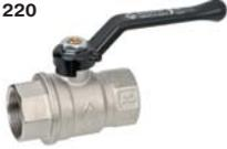
Кран шаровой латунный, полнопроходной, резьбы внутренняя - внутренняя по ISO 7:2000, рычаг из алюминия.
