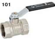
Кран шаровой латунный, неполнопроходной, резьбы внутренняя - внутренняя по ISO 7:2000, рычаг из стали или "бабочка" из алюминия. Температура рабочей среды от -20°C до +120°C.
