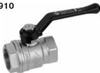
Кран шаровой латунный, полнопроходной, резьбы внутренняя - внутренняя по ISO 228/1, рычаг из алюминия.
