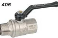
Кран шаровой латунный усиленного типа, резьбы внутренняя - наружная по ISO 7:2000. Температура рабочей среды от -20°C до +120°C.
