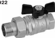
Кран шаровой, латунный, полнопроходной, резьбы внутренняя - наружная (соединитель с накидной гайкой) по ISO 228/1, "бабочка" из алюминия
