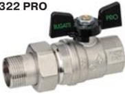
Кран шаровой, латунный, полнопроходной, для высокотемпературных магистралей, резьбы внутренняя - наружная (соединитель с накидной гайкой) по по 228/1, "бабочка" из алюминия.
