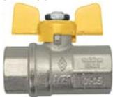
Кран шаровой, для газа, латунный, усиленного типа, полнопроходной, резьбы наружная - внутренняя по ISO 7/1, "бабочка" из алюминия. Температура рабочей среды от -20°C до +60°C.
