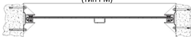
**Габаритные размеры щитового затвора со штурвалом (выдвижной шток), вариант монтажной конструкции ЕС 150 x 150 до 2000 x 2000**
