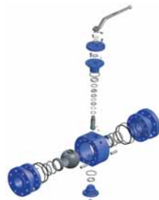
Конструкция крана с двумя опорами шара
