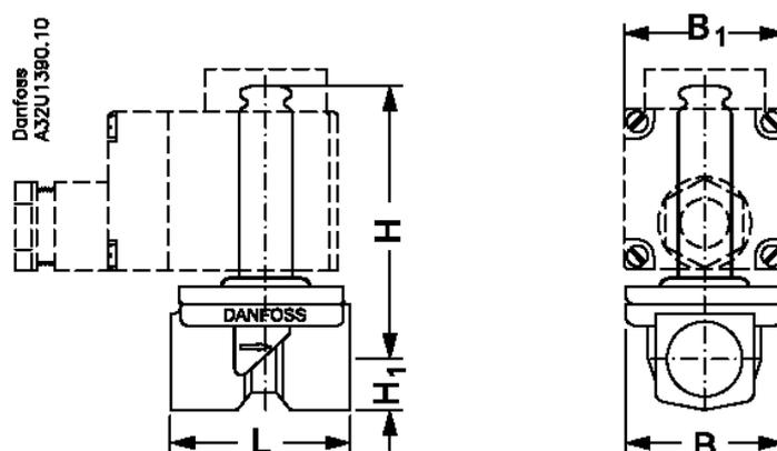
Рис. 3. Габаритные и присоединительные размеры соленоидного клапана.
