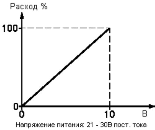
Этот тип катушек предназначен для работы с нормированным сигналом по напряжению 0 – 10В. Зависимость между величиной управляющего напряжения и степенью открытия клапана строго линейная.
