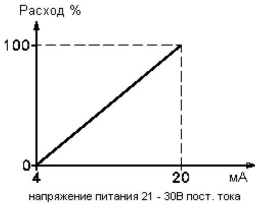
Катушки типа BL с преобразователем сигнала
