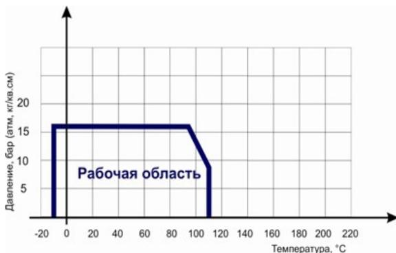
Диаграмма определяет рабочую область для фильтра сетчатого латунного резьбового в координатах Давление (в барах приборного) / Температура (° C).
