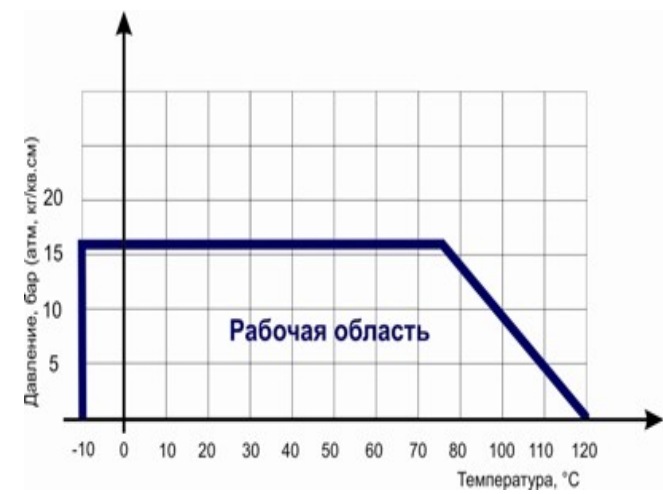
Диаграмма Давление / Температура для задвижки клиновой ABRA A40-16G-BS с обрезиненным клином и невымвдвжнм штокм Ду 040-600, Ру 16:
