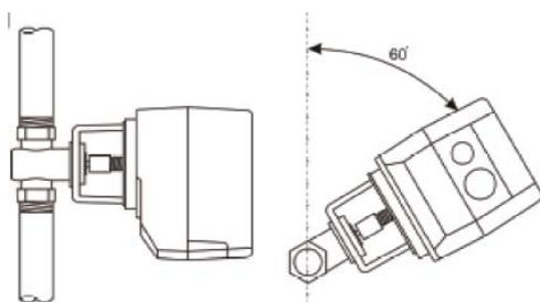
На горизонтальный трубопровод электропривод необходимо ставить под углом в промежутке от 0° до 60° относительно вертикальной оси. Причем чем выше температура регулируемой среды (более 80 °С) угол
