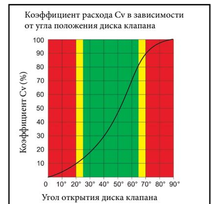
Предполагаемая площадь эффективного регулирования расхода достигается между углом открытия 25° и углом 65° (зеленая область). В некоторых случаях, допустимо расширить диапазон углов между 20° и 70° (желтая область).
