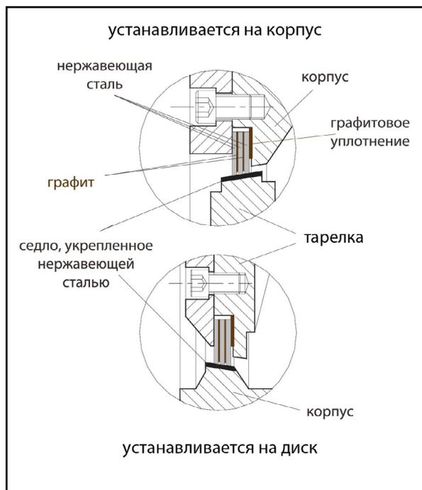
Диск поворотного затвора жестко установлена на один вал посредством штифтов. Самоцентрирующееся седло устанавливается или на корпус, или на диск поворотного затвора. Уплотняющая поверхность укреплена покрытием из нержавеющей стали (см. развернутую схему ниже). Уплотняющая поверхность, укрепленная стеллитом, также предоставляется по требованию. Вал уплотнен графитовыми вкладышами и может уплотняться дополнительно. Крепление вала устойчиво к температурным изменениям текущей среды.
