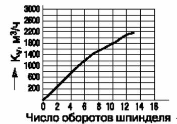
Рис.42. Диаграмма для настройки MSV-F Plus,  $D_y = 400$  мм. Взято из(RC.08.A6.50)
