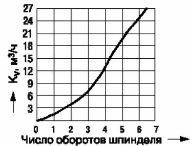
Рис.31. Диаграмма для настройки MSV-F Plus,  $D_y = 40$  мм. Взято из(RC.08.A6.50)
