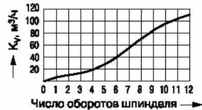
Рис.18. Диаграмма для настройки MSV-F,  $D_v = 80$  мм. Взято из(RC.08.A6.50)
