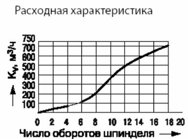
Рис.22. Диаграмма для настройки MSV-F,  $D_y = 200$  мм. Взято из(RC.08.A6.50)
