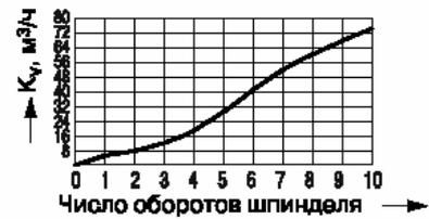
Рис.17. Диаграмма для настройки MSV-F,  $D_v = 65$  мм. Взято из(RC.08.A6.50)
