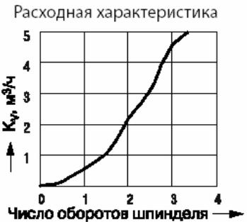
Рис.27. Диаграмма для настройки MSV-F Plus,  $D_y = 15$  мм. Взято из(RC.08.A6.50)
