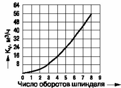
Рис.33. Диаграмма для настройки MSV-F Plus,  $D_y = 65$  мм. Взято из(RC.08.A6.50)
