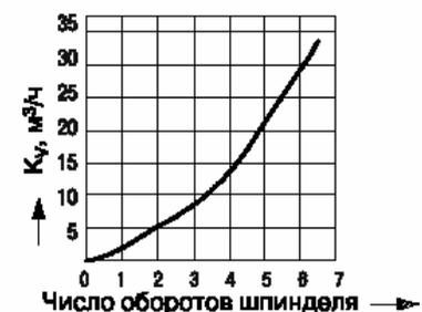
Рис.32. Диаграмма для настройки MSV-F Plus,  $D_y = 50$  мм. Взято из(RC.08.A6.50)
