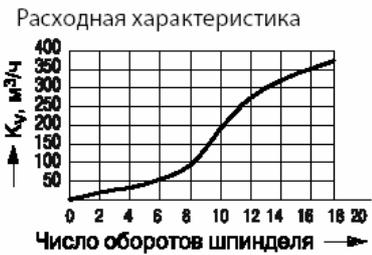
Рис.21. Диаграмма для настройки MSV-F,  $D_y = 150$  мм. Взято из(RC.08.A6.50)
