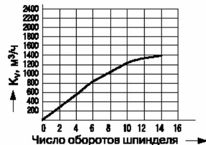
Рис.40. Диаграмма для настройки MSV-F Plus,  $D_v = 300$  мм. Взято из(RC.08.A6.50)
