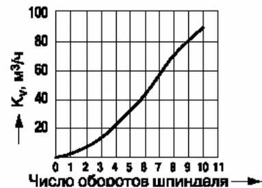
Рис.34. Диаграмма для настройки MSV-F Plus,  $D_y = 80$  мм. Взято из(RC.08.A6.50)
