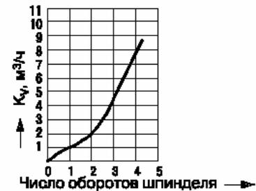
Рис.29. Диаграмма для настройки MSV-F Plus ,  $D_y = 25$  мм. Взято из(RC.08.A6.50)
