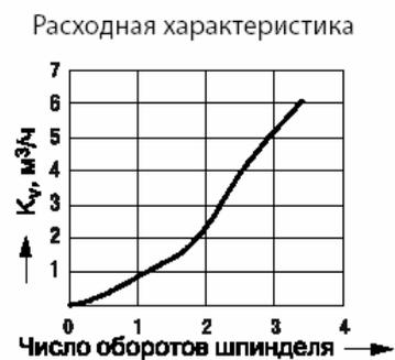
Рис.28. Диаграмма для настройки MSV-F Plus,  $D_y = 20$  мм. Взято из(RC.08.A6.50)
